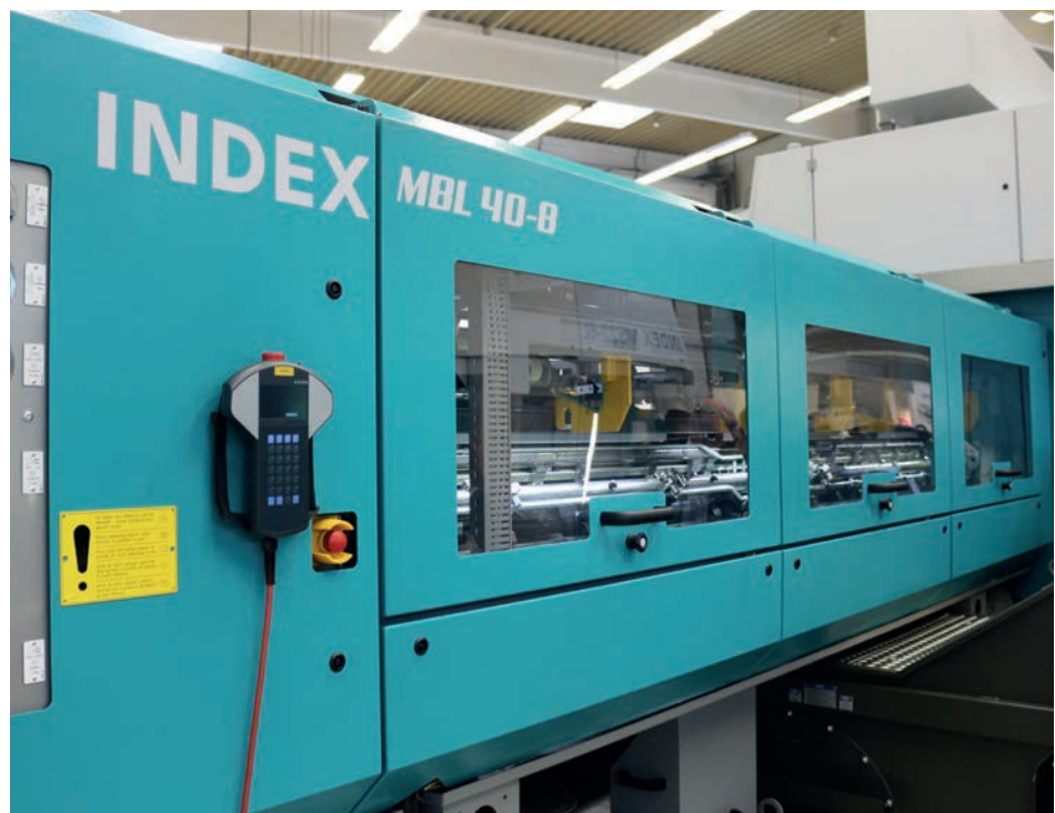
Voor het nauwkeurig beladen van de meerspindelautomaten bij de enorme bewerkingssnelheden heeft Index een eigen stangenlader ontwikkeld.
