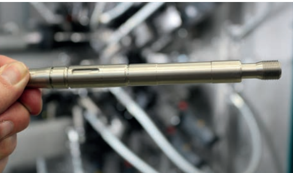
De meerspindelautomaten zijn nog steeds de machines voor grote series. Bewerkingstijd van dit werkstuk bedraagt 2,7 seconden.
