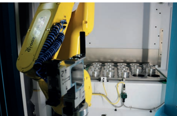
De robotcel beschikt over een Fanuc robot die werkstukken tot 6 kilo (inclusief grijper) kan handlen.
