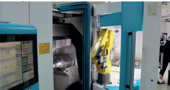
De universele CNC-draaimachine Index C100 en C200 kunnen nu voorzien worden van de geïntegreerde iXcenter robotcel.
