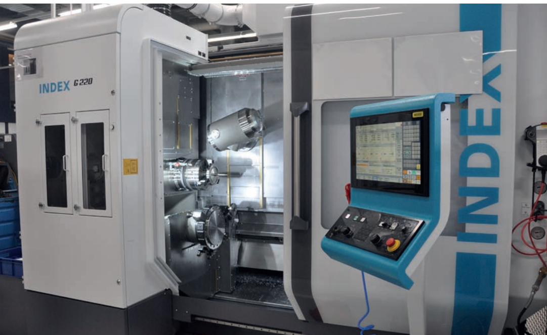
De G220 biedt een doorgang van 65 mm, optioneel 90 mm (klauwplaat Ø tot max 210 mm). De afstand tussen de spindels bedraagt 1280 mm en de maximale draailengte 1000 mm.
