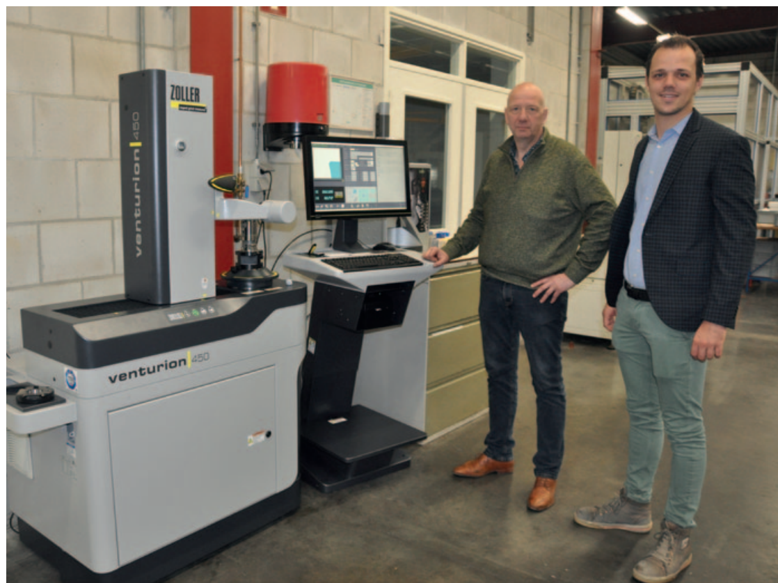
Tom Kusters en Jeroen van der Linden (rechts) bij de Zoller Venturion 450, die data rechtstreeks in de CNC-machine kan schrijven.
