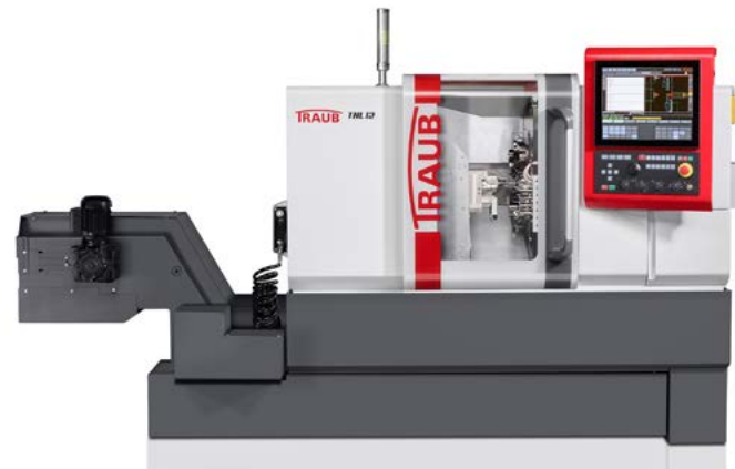
De nieuwe langdraaiautomat Traub TNL12 heeft een compactere bouw met verbeterde kinematica ten opzichte van zijn voorganger. Dat geeft duidelijke productiviteitsverbeteringen bij kleine precisie-draaidelen.
