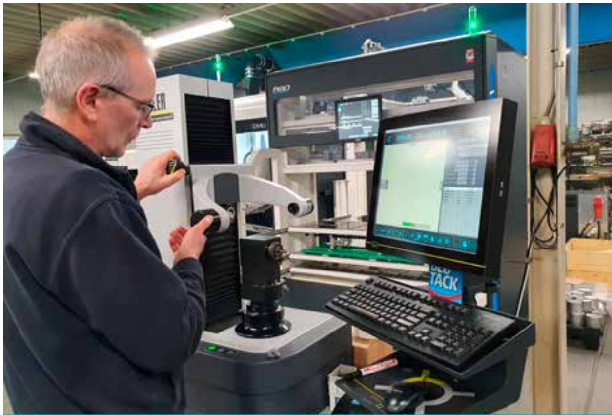
Het gereedschapvoorstel- en meetapparaat Smile 420 van Zoller verricht snelle hoog nauwkeurige metingen en zorgt voor exact ingestelde gereedschappen.
