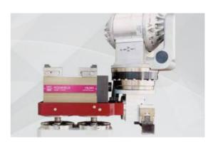
Aan een robotarm kan ook een Stark nulpunt systeem worden bevestigd waarmee de opspanmal opgenomen en gewisseld kan worden.
