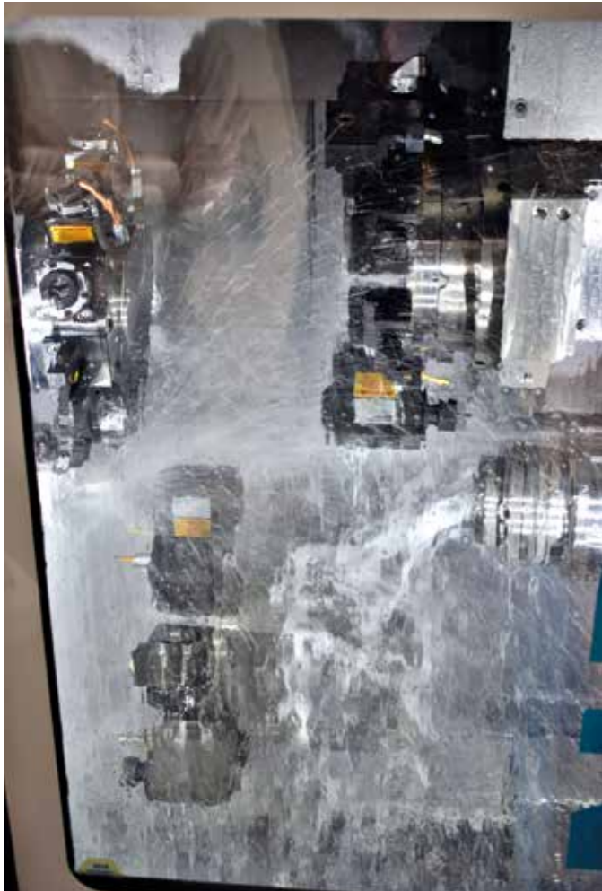
De C100 bij Boers & Co heeft een hoofd- en subspil en drie turrets voor een maximale productiviteit in een compact bewerkingscentrum
