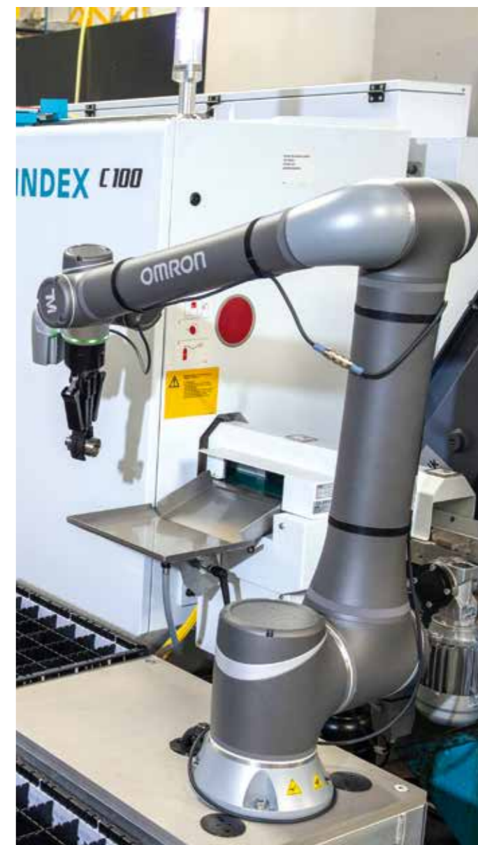
Boers & Co gebruikt in sommige gevallen een cobot om de werkstukken in speciaal ontwikkelde kratten te plaatsen, die vervolgens naar de reinigingsinstallatie gebracht worden
