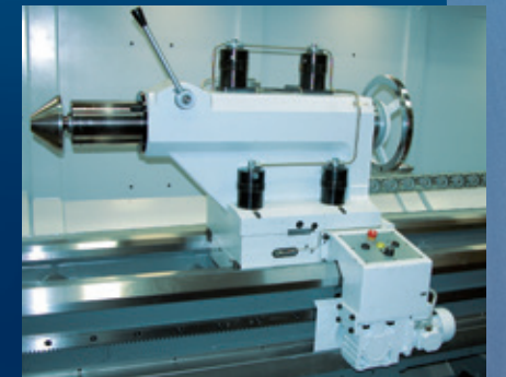
Reitstock mit automatischer Klemmung und eigenem Antrieb
