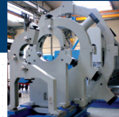
Lünetten bis Durchmesser 1.500 mm
