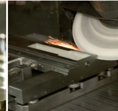
Schleifen d. Schwalbenschwanzführung
