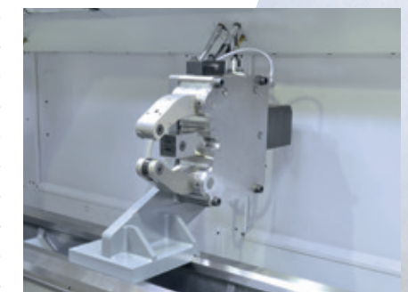
Feststehende, selbstzentrierende Lünette, hydraulisch betätigt
