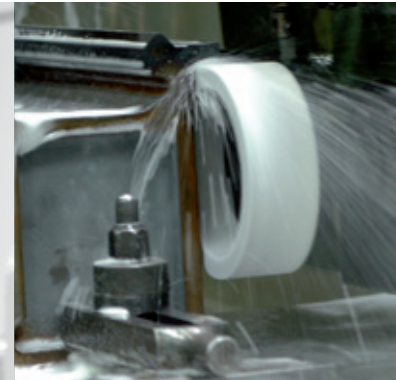
Schleifen eines Maschinenbettes
