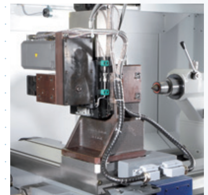
Y-Achse mit 200 mm Hub
