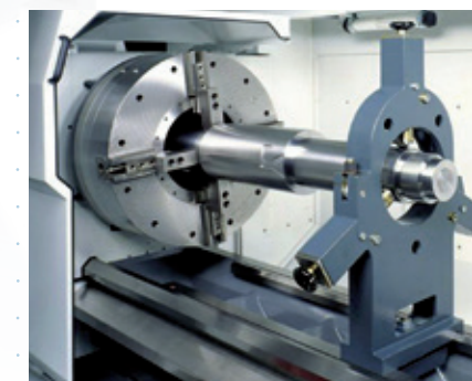
Pneumatisch betätigtes Vorderendfutter und feststehende Lünette
