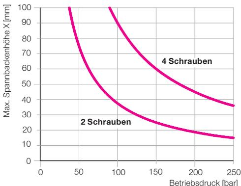
**Befestigung der Spannbacken**
