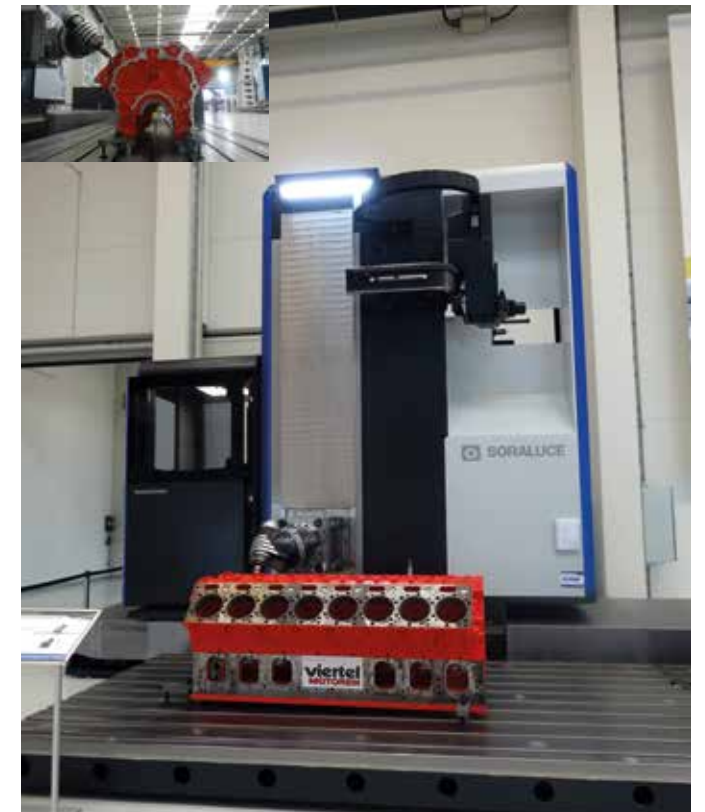
Het nauwkeurig opspannen van grote zware werkstukken is tijdrovend. Soraluce heeft een systeem ontwikkeld waarmee de locatie van werkstukken wordt bepaald alvorens er bewerkt wordt. De positionering van het werkstuk is daardoor minder van belang
