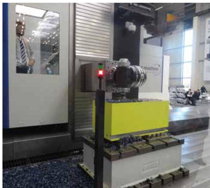
Met een proefopstelling presenteerde Soraluce het effect van het DAS- en DPS-systeem waarmee ongewenste trillingen kunnen worden voorkomen (foto's: Tim Wentink)
