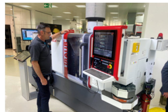
De Traub TNL12, een automatische draaibank met verschuifbare kop
