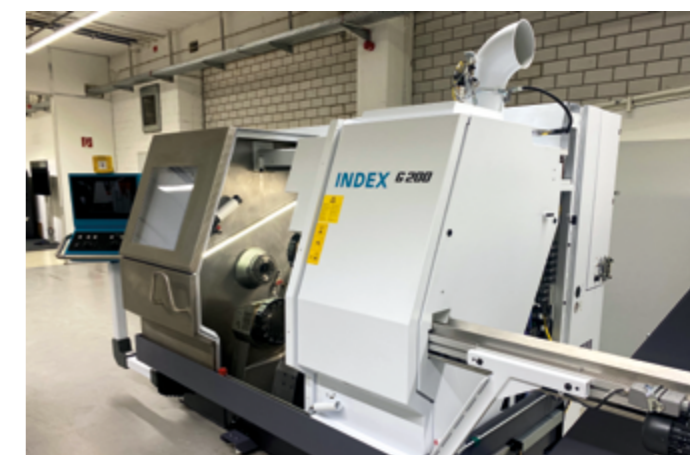
Bij alle Index G-machine modellen is de gemotoriseerde freesspil die boven de rotatie-as is geplaatst met een hydrodynamisch gemonteerde Y/B-as een belangrijk element van de machine
