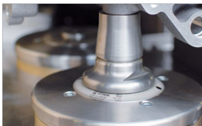
Patentiertes positionsflexibles Spannelement in x/y/z-Richtung
